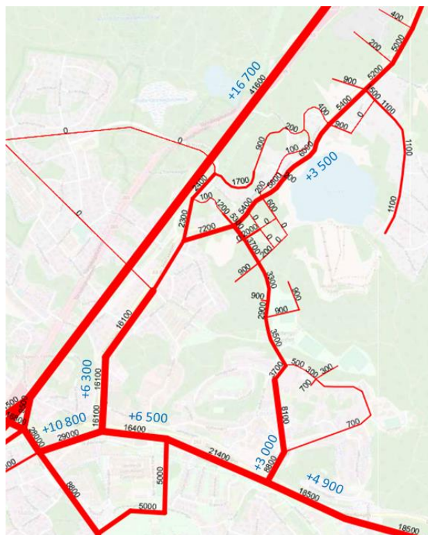
Figur 16. De modellerade trafikflödena under ett vintervardagsdygn år 2026.
