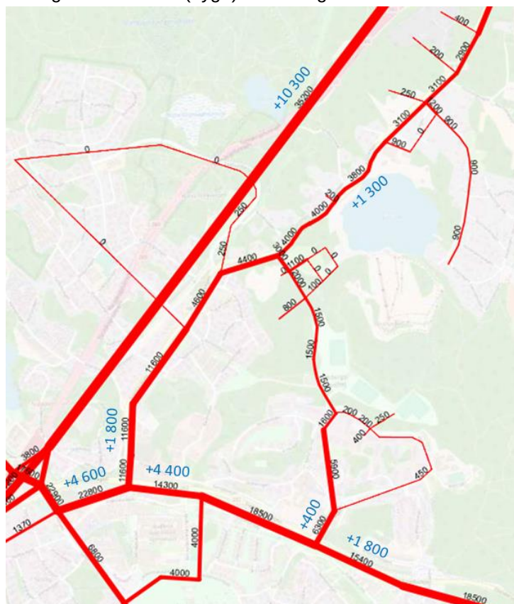
Figur 10. De modellerade trafikflödena under ett vintervardagsdygn år 2020.
