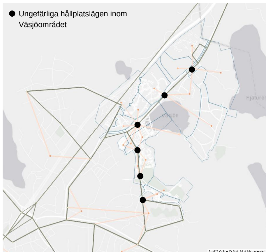
Figur 7. Länkar och skaft i kollektivtrafiknätet. De svarta prickarna visar i vilket område hållplatserna kommer vara placerade. I modellen är hållplatserna ej placerade på exakt den plats där de ska vara i verkligheten. Detta då analysen är gjord i en makromodell som ej har sådan detaljeringsgrad att den exakta placeringen är av betydelse.
