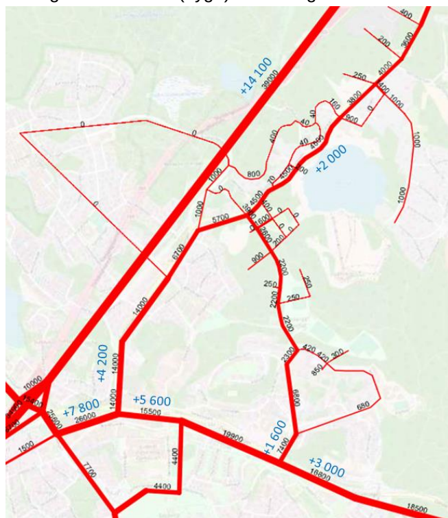
Figur 12. De modellerade trafikflödena under ett vintervardagsdygn år 2022.
